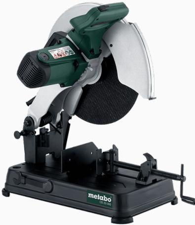
Potente motor de 2300W que permiten cortar perfiles, tubos, barras de acero, hierro fundido con disco de 355mm/14". Compacta y liviana facilita su transporte al sitio de obra. Motor y engranajes suspendidos en rodamientos Posee una base regulable de ajuste rápido que permite cortes de 90° hasta 45°.
